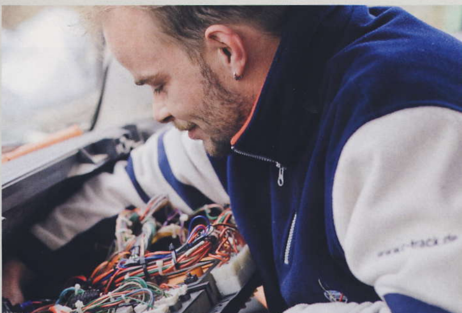
Die Hardware inklusive GPS-Sender wird vom Monteur des Anbieters versteckt hinter dem Handschuhfach im Armaturenbrett eingebaut. | Foto: DigiCore.
