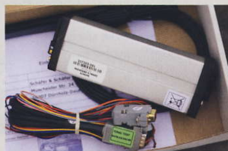
Die komplette C-Track Hardware für ein Fahrzeug vor dem Einbau. Eine zusätzliche Antenne auf dem Fahrzeug ist nicht mehr nötig.
