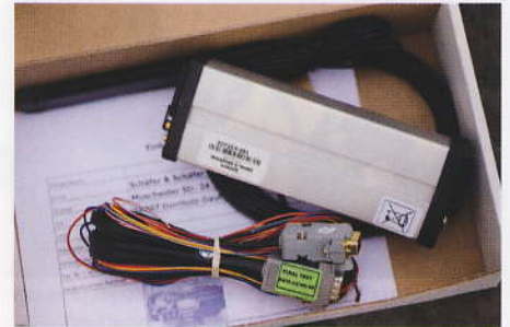
Dieser kleine silberne Kasten protokolliert Leerlauf- und Betriebszeiten des Motors und weiß immer, wo ein Fahrzeug steht oder fährt.
